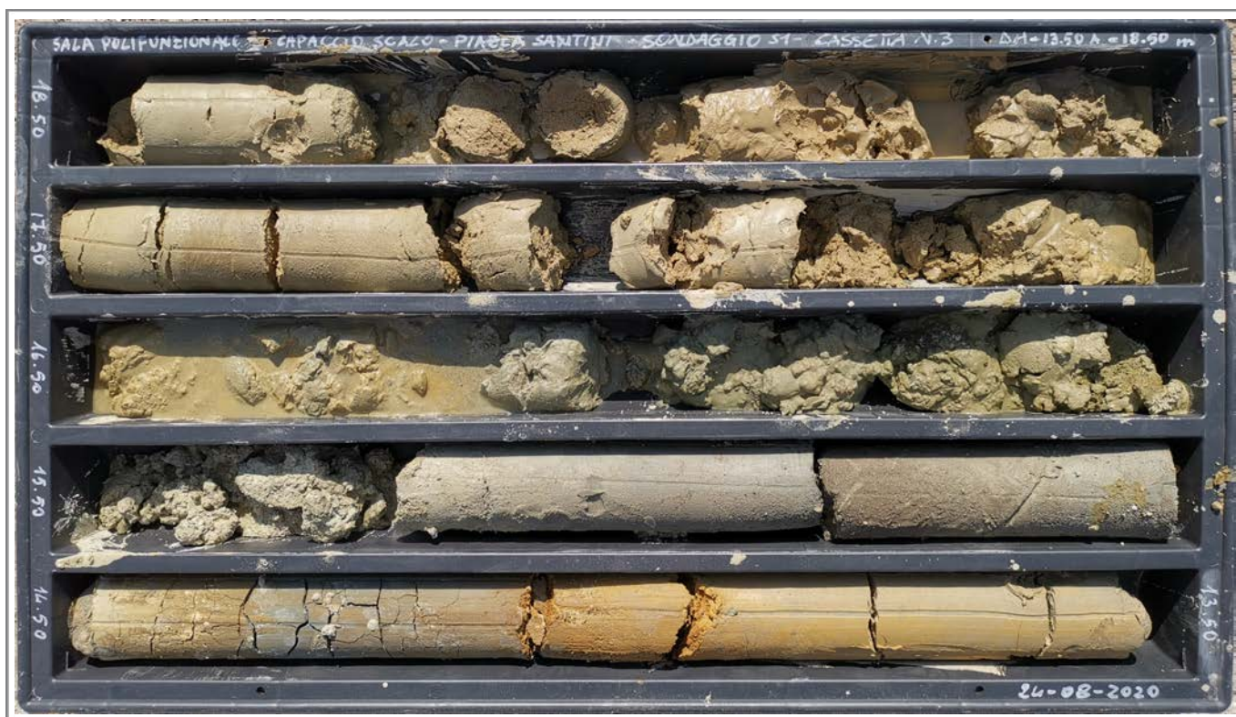
Sondaggio S1 - Cassetta n.3 - da -13,50 a -18,50 metri
