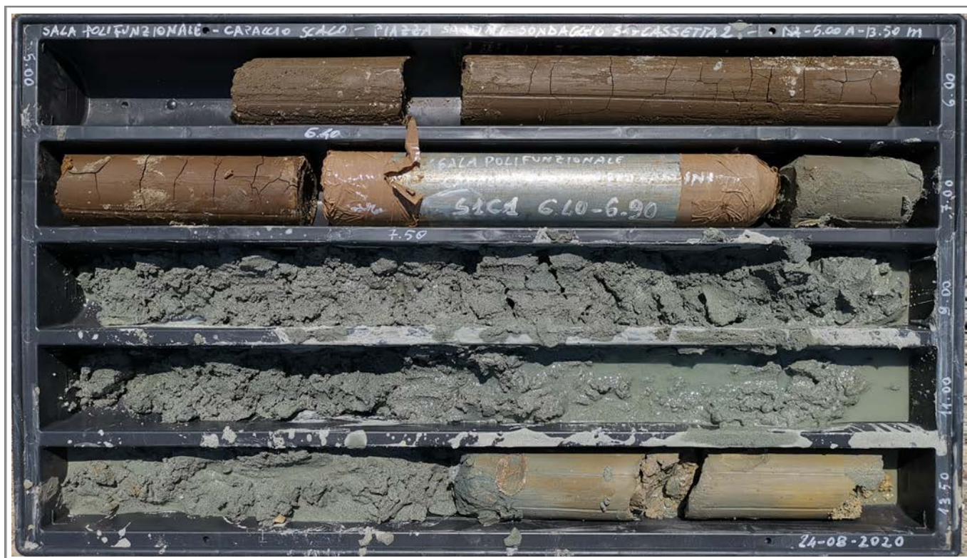
Sondaggio S1 - Cassetta n.2 - da -5,00 a -13,50 metri
