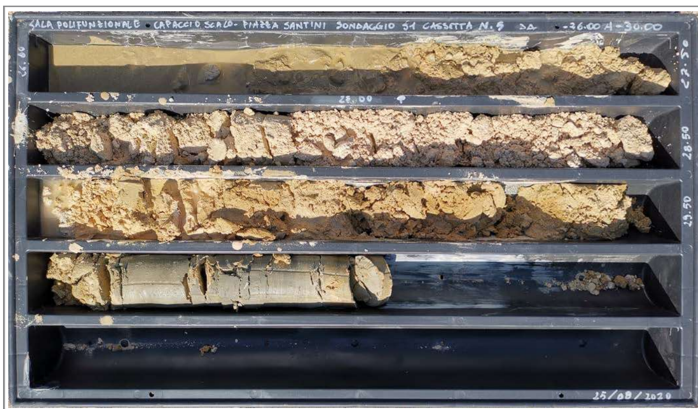
Sondaggio S1 - Cassetta n.5 - Da -26,00 a -30,00 metri
