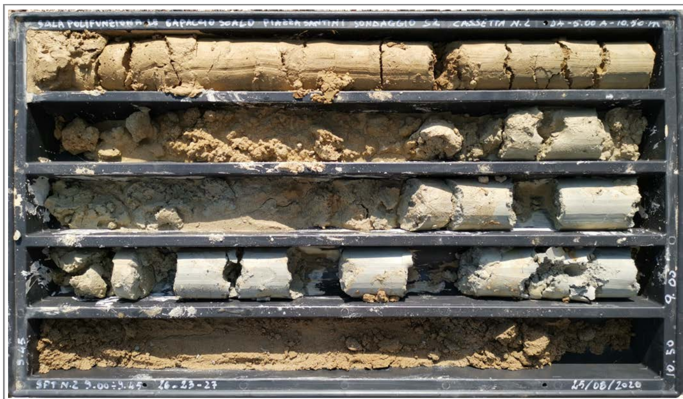
Sondaggio S2 - Cassetta n.2 - da -5,00 a -10,50 metri
